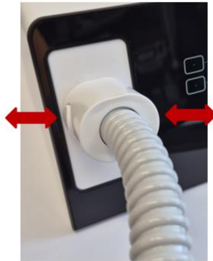
Abb. 10: Bewegungsrichtung der Knöpfe der Saugkammerverriegelung
