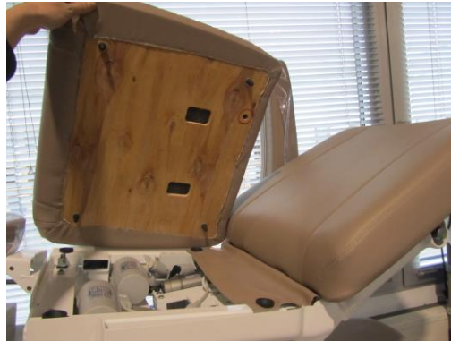
Abb. 14: Lösen des Sitzpolsters
