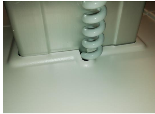
Abb. 9: Spiralkabel im vorgesehenen Schlitz
