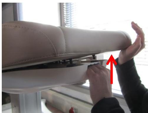
Abb. 16: Hochdrücken des Rückenpolsters
