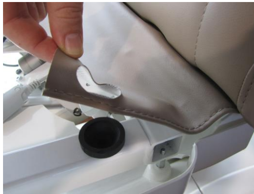
Abb. 15: Lösen des Schutzlappens von den Gummihaltern
