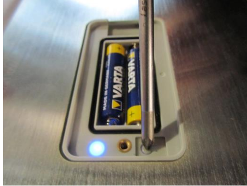
Abb. 33: Batteriefach des Multifunktions-Fußtasters
