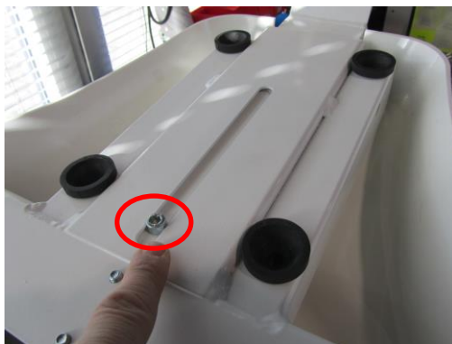
Abb. 18: Befestigung der Führungsschraube
