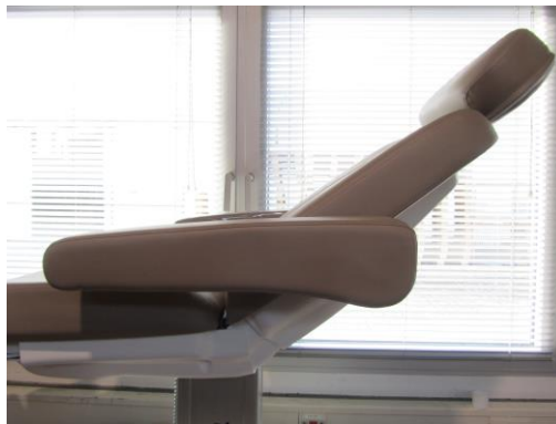
Abb. 26: Drehung der Armlehne um 90° nach vorn
