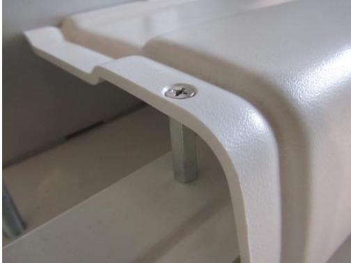
Abb. 6: Aufsetzen auf Grundgestell
