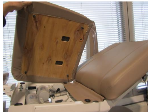
Abb. 14: Lösen des Sitzpolsters
