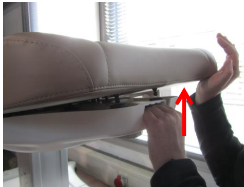
Abb. 16: Hochdrücken des Rückenpolsters
