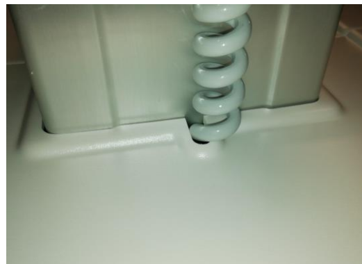
Abb. 9: Spiralkabel im vorgesehenen Schlitz
