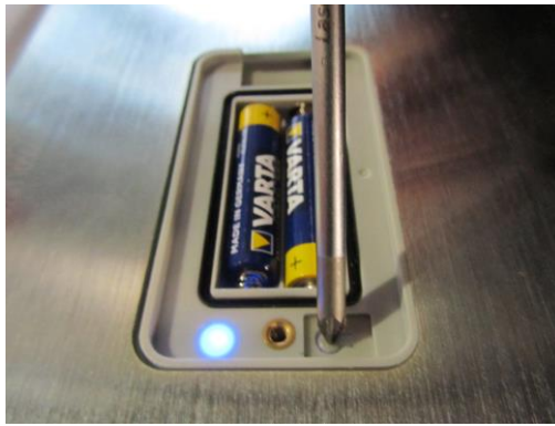
Abb. 33: Batteriefach des Multifunktions-Fußstasters
