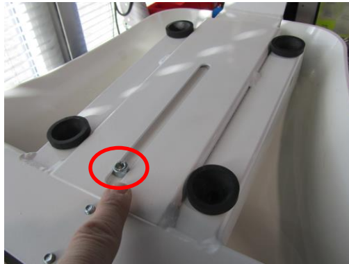
Abb. 18: Befestigung der Führungsschraube
