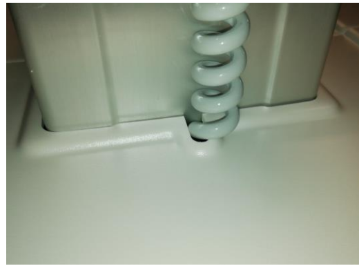
Abb. 9: Spiralkabel im vorgesehenen Schlitz
