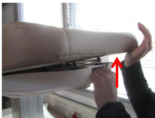
Abb. 16: Hochdrücken des Rückenpolsters
