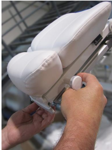
Abb. 30: Verstellen des Fersenauszugs
