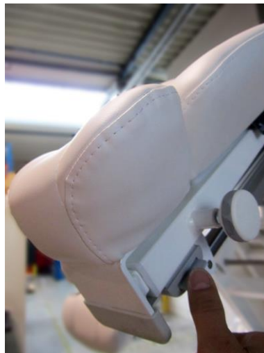
Abb. 28: Wippenschalter zur Verstellung der Beinauflage
