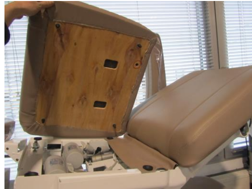
Abb. 14: Lösen des Sitzpolsters
