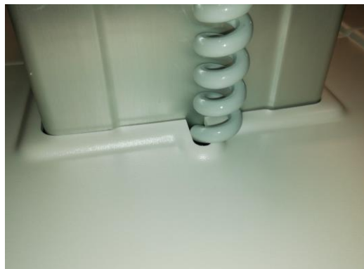
Abb. 9: Spiralkabel im vorgesehenen Schlitz
