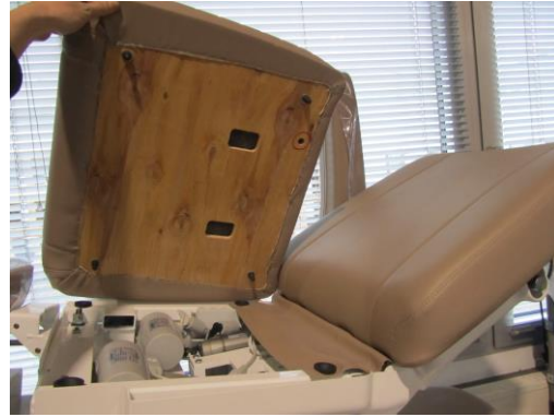
Abb. 12: Lösen des Sitzpolsters
