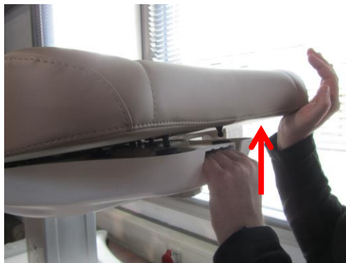
Abb. 14: Hochdrücken des Rückenpolsters
