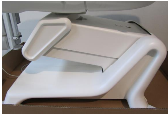
Abb. 8: Aufsetzen der linken Hälfte der Verkleidung
