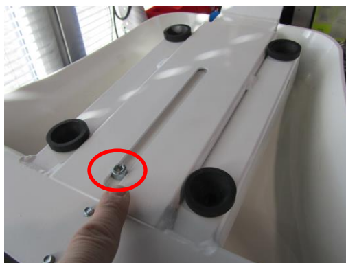
Abb. 16: Befestigung der Führungsschraube
