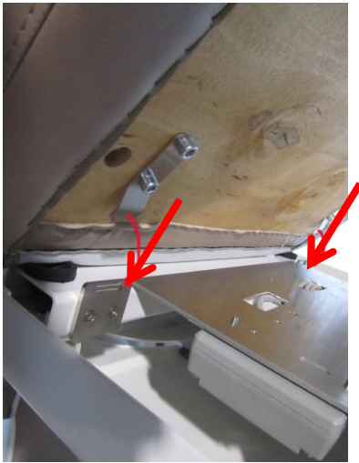
Abb. 18: Halter am Rückenrahmen
