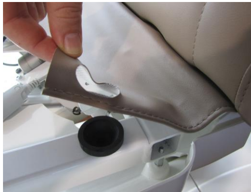
Abb. 13: Lösen des Schutzlappens von den Gummihaltern
